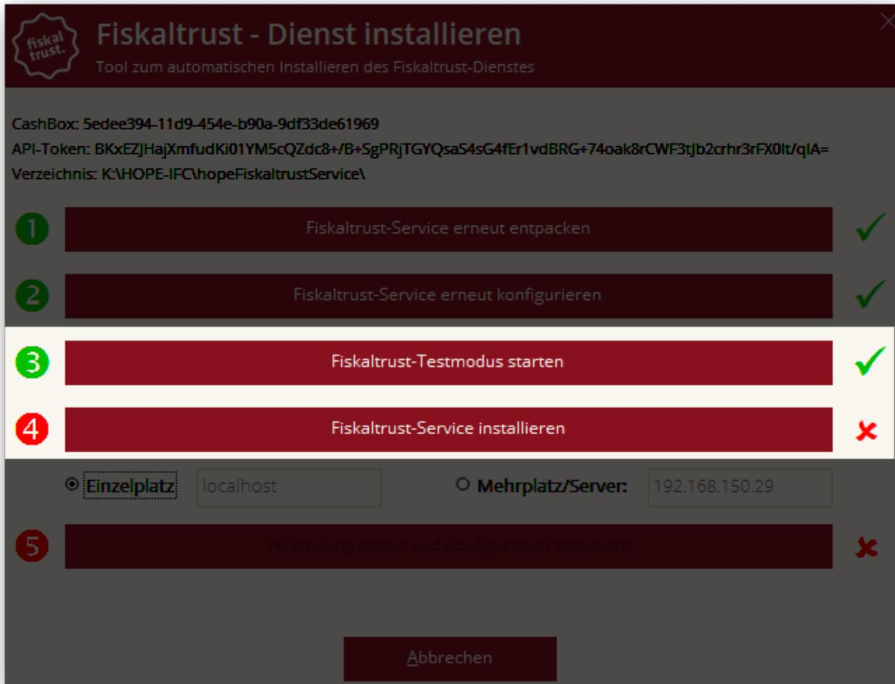
Zur Installation klicken Sie den entsprechenden Button. Es wird nun versucht, den Dienst in Ihrem System einzurichten und zu starten. Wird die Ziffer 4 grün hinterlegt, konnte der Dienst installiert werden.
